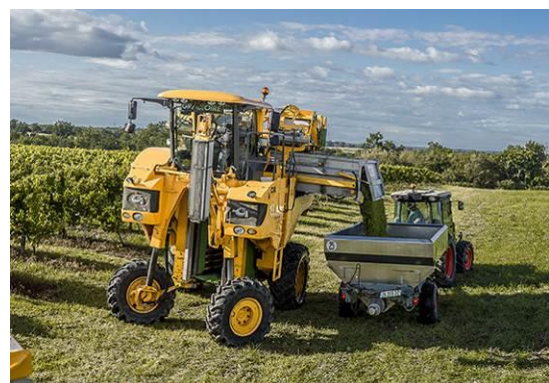
【▲収穫の際に使用される可動式の冷蔵タンク】
